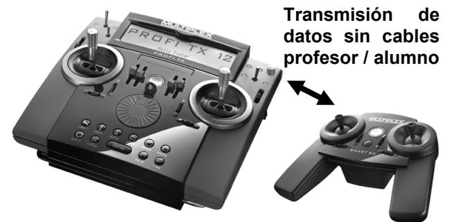
Modo profesor / alumno con una PROFI TX de MULTIPLEX con módulo profesor / alumno
