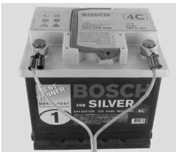
Anschluss mit dem beiliegenden 12 V Anschlusskabel an eine Autobatterie
