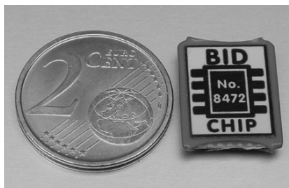
BID-čip bez kabelu, k vybavení dalších akumulátorů. č. 308472
