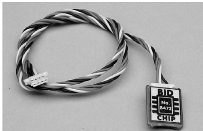
BID-Chip con cable de 300 mm, para equipar otras baterías No. 308473
