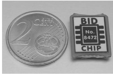
BID-Chip ohne Kabel, zur Ausstattung weiterer Akkus. No. 308472
