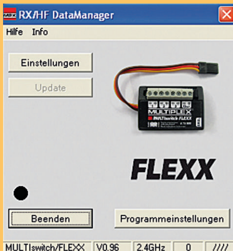
Der FLEXX-Schaltbaustein wird sofort erkannt, sobald er über das USB-Kabel mit einem PC bzw. Notebook verbunden wird
