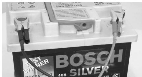
Connexion à une batterie de voiture avec le cordon d'alimentation 12 V fourni.
