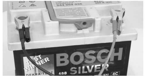
Anschluss mit dem beiliegenden 12 V Anschlusskabel an eine Autobatterie.
