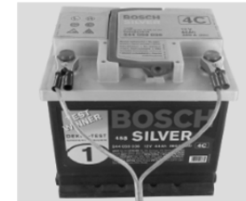
Anschluss mit dem beiliegenden 12V Anschlusskabel an eine Autobatterie (Polklemmen optional)
