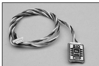
Chip-BID con cavo da 300 mm per equipaggiare anche altri accumulatori N. 308473
