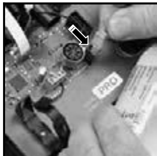
Fig. 9.4.4.2.: branchement de l'accu
